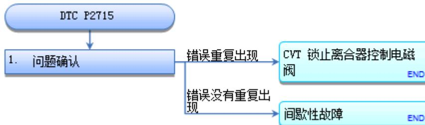
**DTC P2715:** 压力控制电磁阀 "D" 卡在 ON 位置
